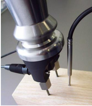
Bild 4: Hohlhammerlektrode mit Temperaturfühler
