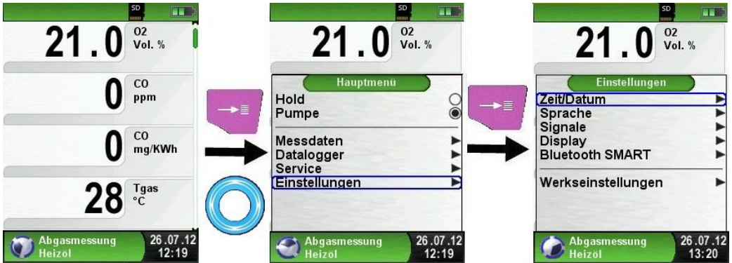
Bild 11: Konfigurationsmenü „Einstellungen“ im Hauptmenü, Bsp.: Abgasmessung
