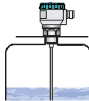
Abb. 7: Installation des Füllstandmessers im nichtmetallischen Tank
