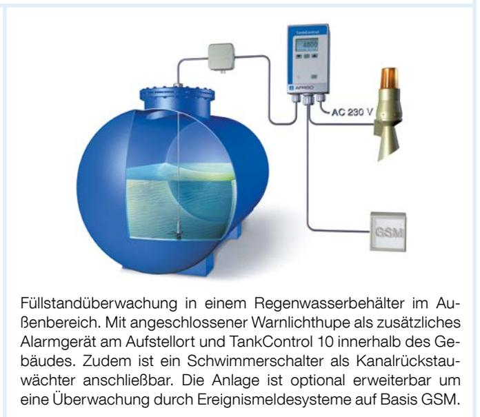
Füllstandüberwachung in einem Regenwasserbehälter im Außenbereich. Mit angeschlossener Warnlichthupe als zusätzliches Alarmgerät am Aufstellort und TankControl 10 innerhalb des Gebäudes. Zudem ist ein Schwimmerschalter als Kanalarückstauwächter anschließbar. Die Anlage ist optional erweiterbar um eine Überwachung durch Ereignismeldesysteme auf Basis GSM.
