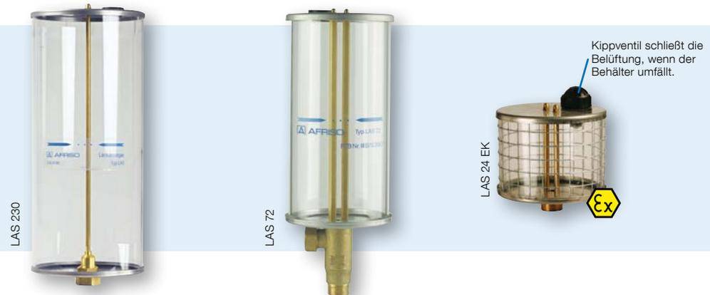
**Anwendung** Für oberirdische doppelwandige Behälter zur Lagerung wassergefährdender Flüssigkeiten. Einsatz unter atmosphärischen Bedingungen für Tanks aus Stahl und doppelwandige Behälter mit Zulassung für Leckanzeigergeräte. Typ LAS 24 E, LAS 39 E und LAS 72 E für alle wassergefährdenden Flüssigkeiten. Typ LAS 24, LAS 39, LAS 72 und LAS 230 für wassergefährdende Flüssigkeiten mit Flammpunkt > 55 °C.
