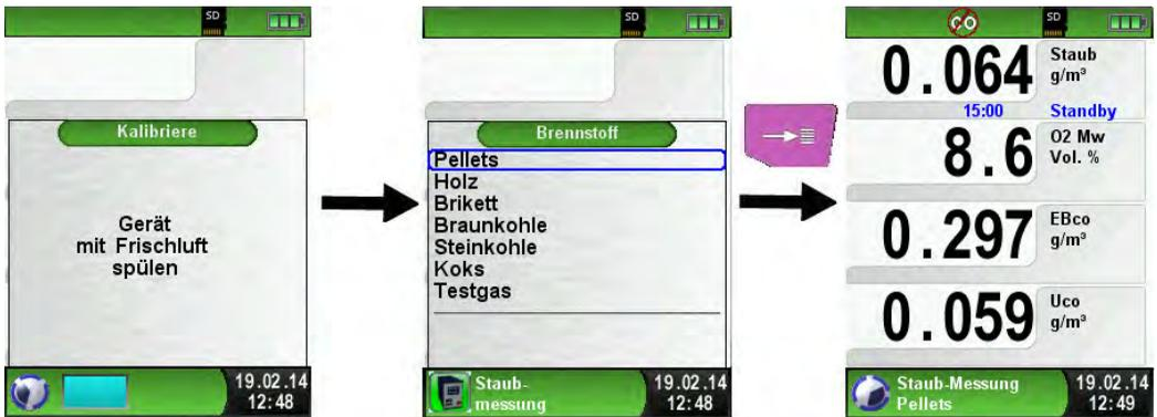
Nun müssen die Parameter am Staubmessgerät gewählt werden. Sobald das Staubmessgerät bereit ist, wird dies auch im MULTILYZER® STx dargestellt. Jetzt kann die Messung entweder am Staubmessgerät oder am MULTILYZER® STx gestartet werden.
