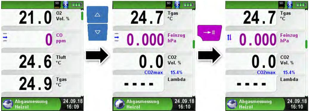
Der Messwert kann nun mit den „Pfeil“-Tasten an die gewünschte Position verschoben werden. Mit der „Zurück“-Taste wird die ausgewählte Position gespeichert und der Messwert wird wieder schwarz.
