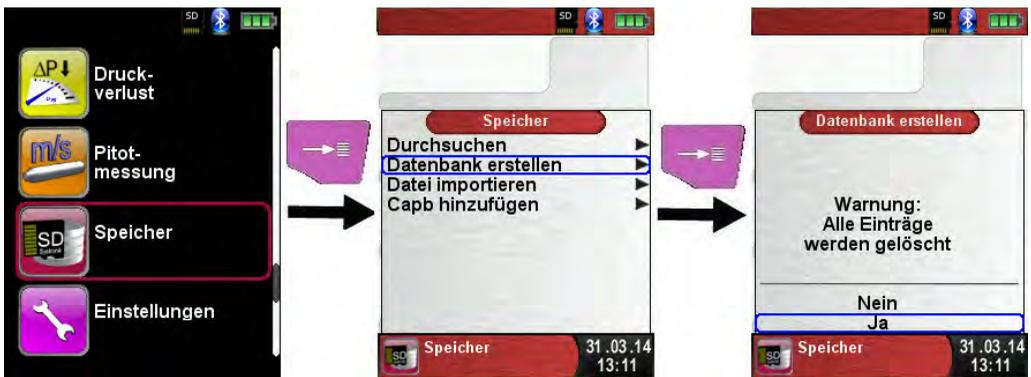
Bei der Prozedur wird auf der MicroSD-Karte eine DATABASE.CSV Datei erstellt, dies stellt die Speicherstruktur des Abgasmessgerätes MULTILYZER® STx dar. Die Prozedur dauert wenige Sekunden.
