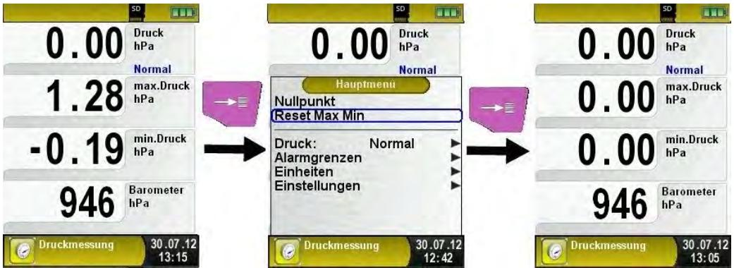
► Geschwindigkeit der Druckmessung.
