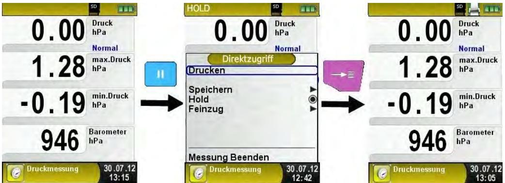
Sobald der Druckbefehl erfolgt ist, wird parallel zum Messbetrieb das Messprotokoll ausgedruckt (→ Multi-Tasking-Funktion), d. h. ohne Einschränkung des Messbetriebs.
