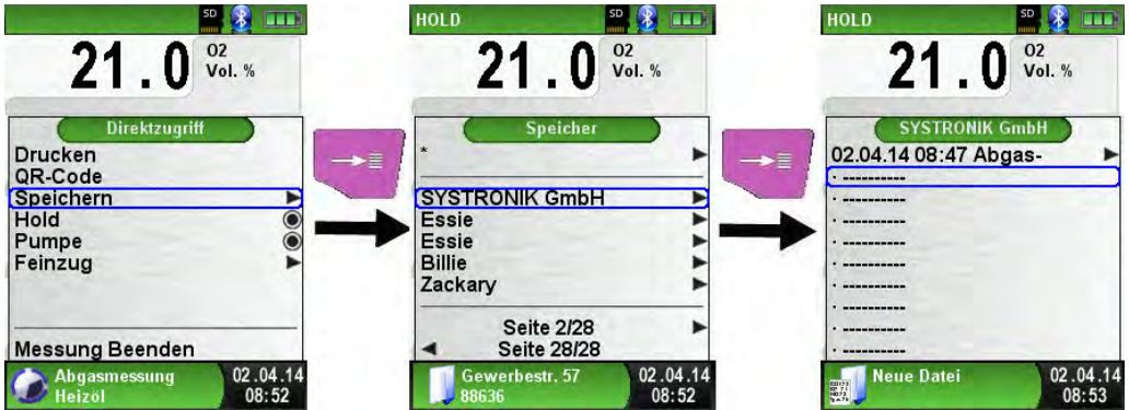
Die gespeicherte Datei kann man folglich anzeigen, ausdrucken oder gegebenenfalls auch mit einer neuen Messung überschreiben. Die gespeicherten Messwerte werden nun zusammen mit den Kundendaten über Bluetooth oder dem QR Code übertragen. Der Dateiname und Speicherort jeder Messung wird im unteren Info Bereich dargestellt. In diesem Beispiel: Speicherordner: MEMO-RY/0000 und Dateinamen 0000\_01.txt:
