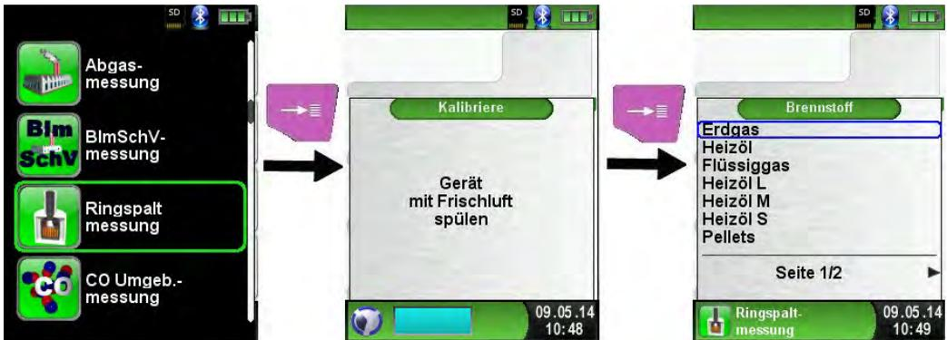
Es kann sowohl eine CO-Messung nach KÜO (Kehr- und Überwachungsordnungen der Bundesländer) als auch eine Ringspaltmessung (O<sub>2</sub>-Differenz im Ringspalt) durchgeführt werden. Somit wird ermittelt, ob Abgase in die Verbrennungsluft gelangen. Dazu gibt es als Zubehörartikel die Ringspaltsonde. Des Weiteren kann die Druckdifferenz im Ringspalt ermittelt werden. Diese Druckmessung wird über das Menü „Direktzugriff“ und dem Menüpunkt „Feinzug“ erreicht.
