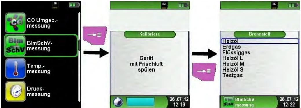
Danach wird die Abgassonde ins Kamin- bzw. Abgasrohr eingeführt. Wenn der O<sub>2</sub>-Wert unter 20% sinkt und beide Temperaturfühler angeschlossen sind, dann wird die 30 Sek. Mittelwertmessung gestartet. Nach den 30 Sekunden wird der berechnete q<sub>A</sub>-Wert angezeigt. Die q<sub>A</sub>-Mittelwertmessung läuft kontinuierlich weiter.
