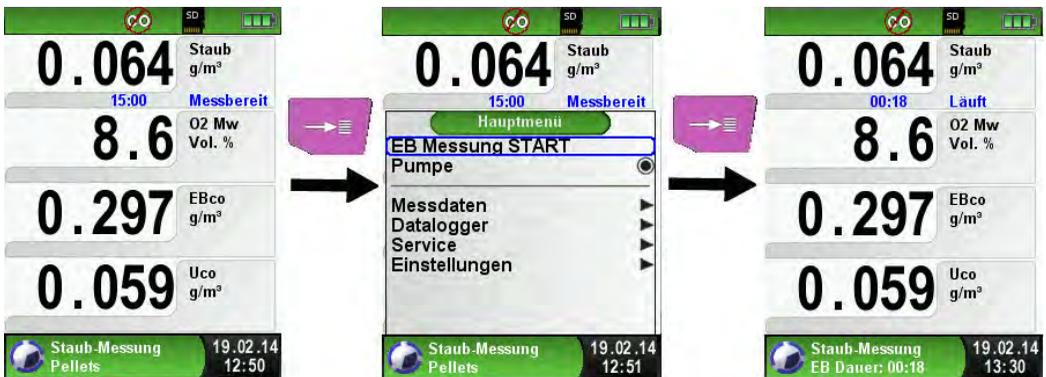
Während der Mittelwertmessung wird die verstrichene Zeit in Minuten angezeigt. Nach Ablauf der 15 Minuten stoppt die Messung automatisch, die berechneten Emissionsbezugswerte (EBco und EBst), die dazugehörigen Messunsicherheiten (Uco und Ust), und die hieraus resultierenden Emissionsbezugswerte abzüglich Messunsicherheit (EBc-U und EBs-U) werden angezeigt. Diese Werte können ausgedruckt werden. Dazu mit der „Pause“ Taste das Direktzugriff-Menü Öffnen und „Drucken“ auswählen.
