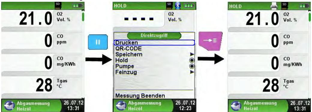
Bild 7: Direktzugriffmenü, Bsp.: Abgasmessung
