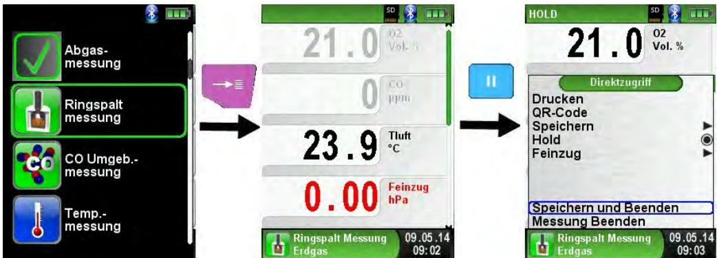
Dies kann mit allen verfügbaren Programmen wiederholt werden. In diesem Beispiel sind die Messdaten aus der Abgasmessung und der Ringspaltmessung zusammengeführt. Nun können über die „HOLD“ Taste die Messdaten gedruckt, gespeichert oder als QR-Code ange-
