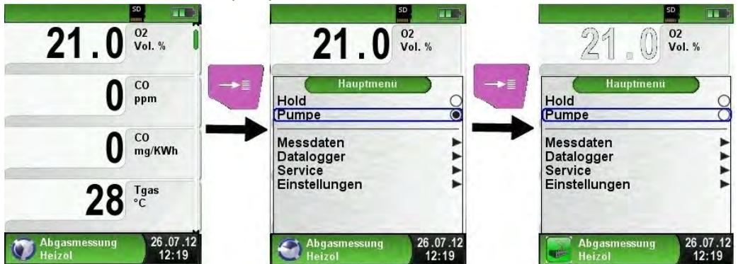
Bei ausgeschalteter Gaspumpe wird in der Statuszeile das Pumpensymbol durch das zugehörige Programmsymbol ersetzt. Die Gasmesswerte werden nun in grauer Farbe dargestellt. Dabei ist nicht auszuschließen, dass entsprechende Gasmesswerte sich ändern können, z. B. der O<sub>2</sub>-Wert aufgrund von „Sauerstoffmangel“ in den geräteinternen Gaswegen. Wird die Gaspumpe für längere Zeit ausgeschaltet, so sollte eine neue Frischluftkalibrierung durchgeführt werden.
