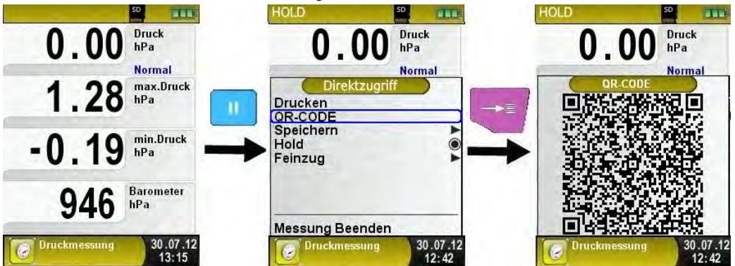
Bild 9: QR-Code generieren, Bsp.: Druckmessung
