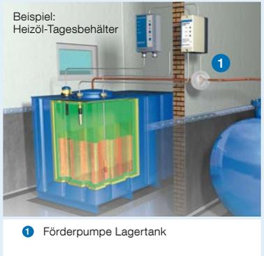
**Anwendung** Einsetzbar für elektrisch nichtleitende Flüssigkeiten, die nicht dickflüssig oder anhaftend sind z. B.: Heizöl, Dieseldieselkraftstoff, nichtaggressive Medien.
