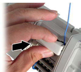
Abbildung 2: Uhr-Funkmodul „FM“ einsetzen
