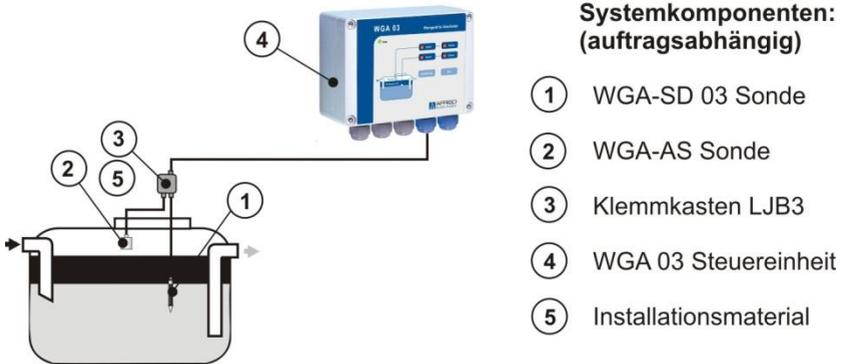
Abbildung 4: Alarmsystem für Ölabscheider mit WGA 03
