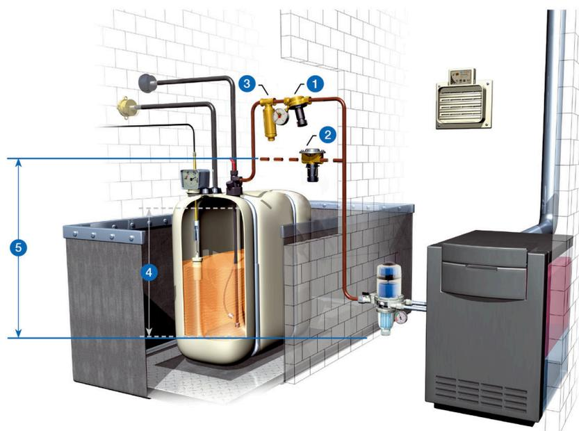
1. Kolben-Antiheberventil KAV
